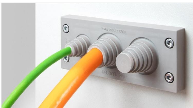
KEL-DPFR 电缆引入底板可以引入多根直径范围在 3mm- 28 mm 的电缆，并且可以满足高达 IP66 的密封等级。当事先不知道确切的电缆直径时，这是一个巨大优势。
